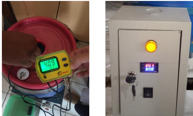
Gambar 5. Pengecekan pH dan Temperatur Selama Fermentasi
