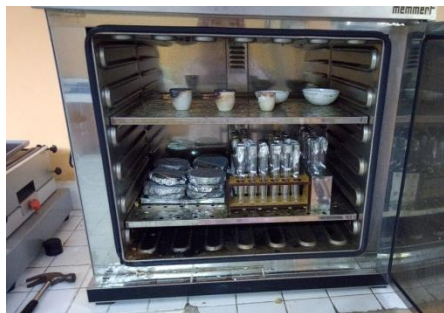
Gambar 12. Crusibel sebelum dan sesudah ditambahkan sampel dimasukkan ke dalam oven (30 menit crusibel kosong, 1 jam crusibel + sampel)
