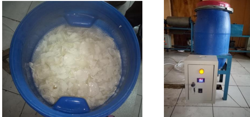
Gambar 4. Bahan Baku (Singkong / Chip , Starter BAL dan Air) dimasukkan ke dalam Fermentor Mocaf dan di Fermentasi
