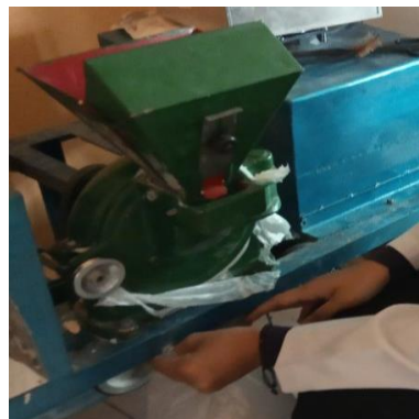
Gambar 9. Chip yang telah kering ditepungkan menggunakan Disc Mill dan tepung yang dihasilkan ditampung menggunakan kantong
