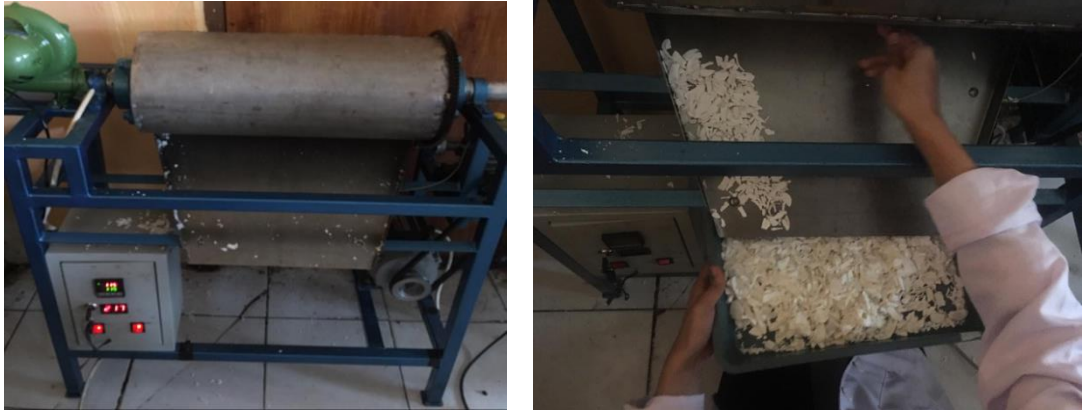
Gambar 7 . Chip yang telah di fermentasi, dicuci dan dimasukkan kedalam rotary dryer untuk dikeringkan
