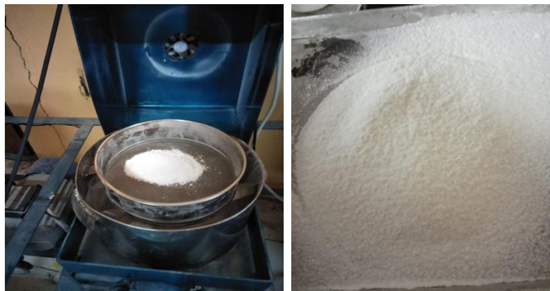
Gambar 11. Tepung diayak menggunakan vibrating screen
