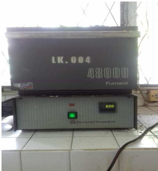
Furnace dengan suhu 850°C selama 5 jam
