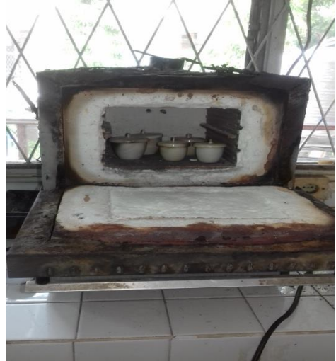
Memfurnace cawan yang telah berisi sampel
