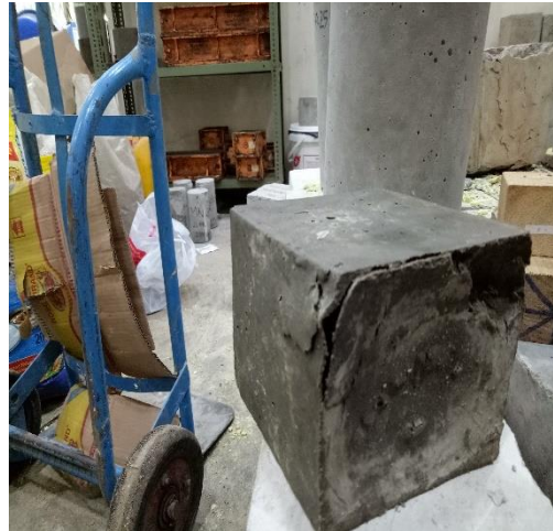
Gambar C.12. Hasil Benda Uji Kuat Tekan
