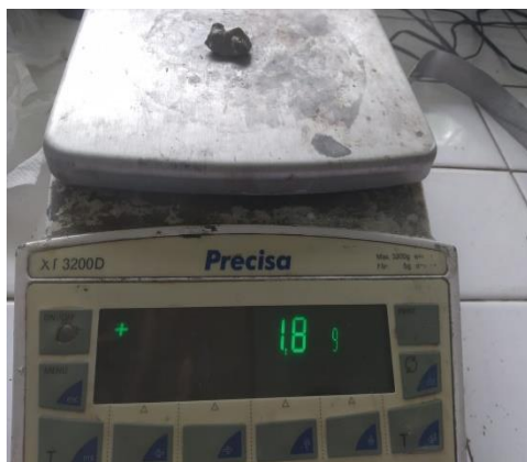
Gambar C.15. Penimbangan sampel (Pengujian Densitas)
