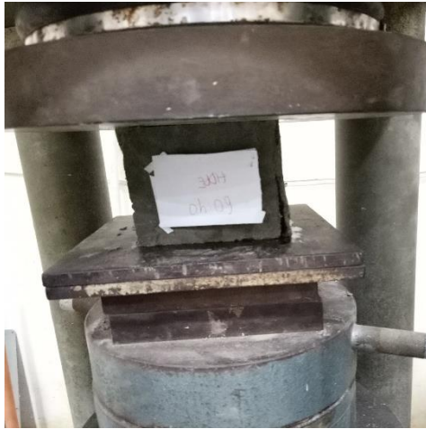
Gambar C.11. Pengujian Kuat Tekan
