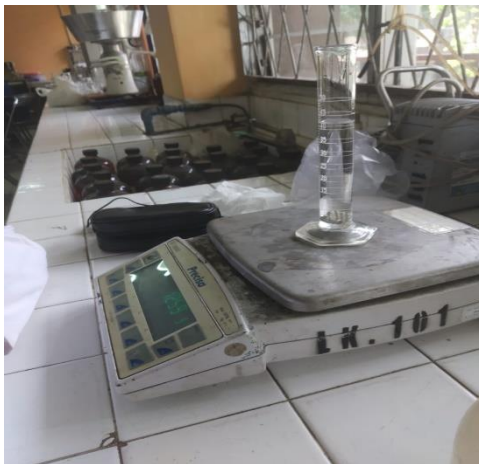
Gambar C.13. Penimbangan Gelas Ukur+Aquadest+Sampel (Pengujian Densitas)
