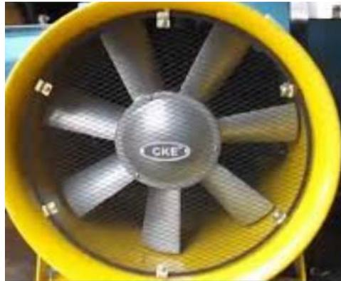
Gambar 6. Kipas/*Fan* pada alat *tray dryer*
