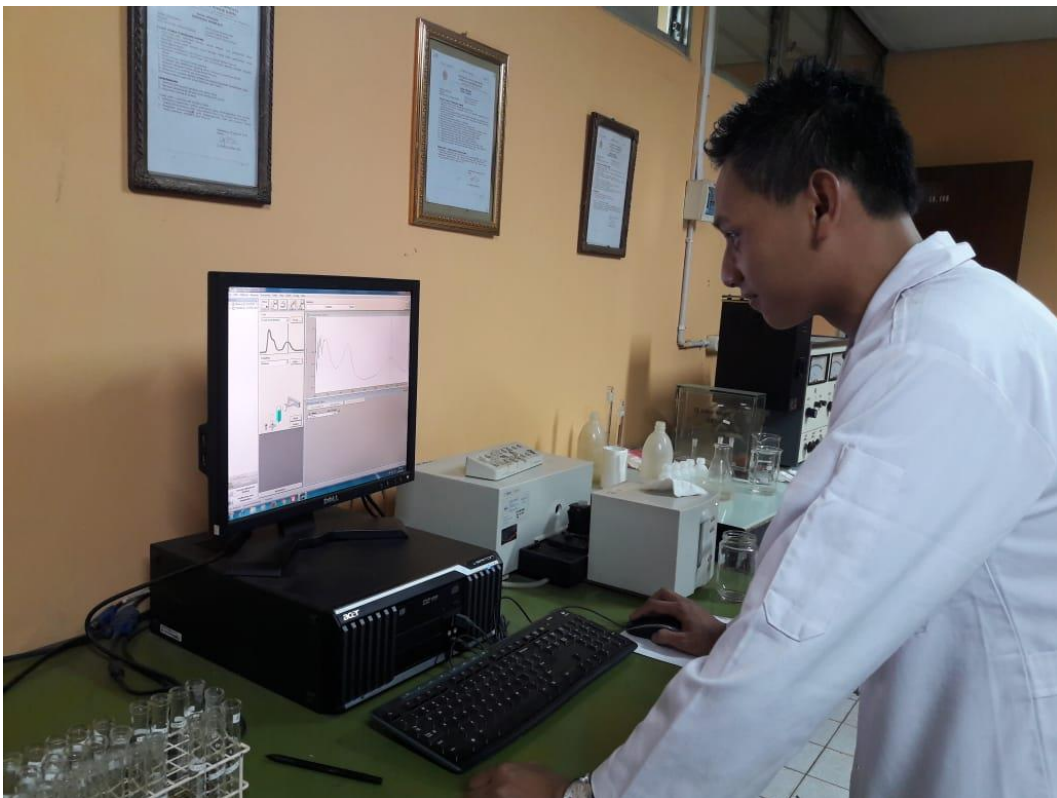
Gambar 8. Penentuan Aktivitas Antioksidan menggunakan spektrometer uv-vis
