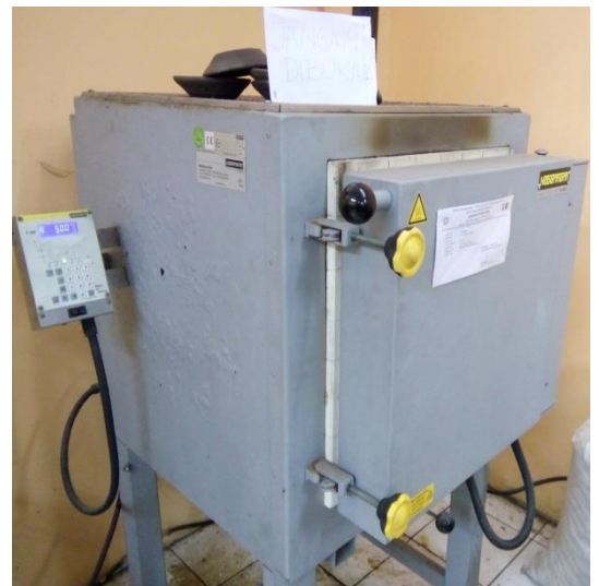
Gambar C.2. Karbonisasi Serbuk Gergaji Kayu Akasia dengan Furnace
