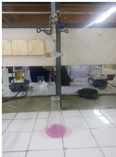
Gambar C.22. Penentuan % FFA dan Bilangan Asam
