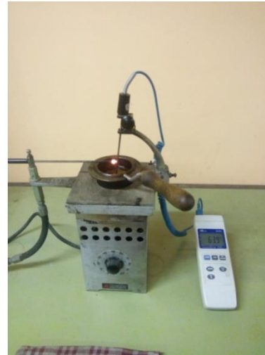
Gambar C.21. Penentuan Titik Nyala
