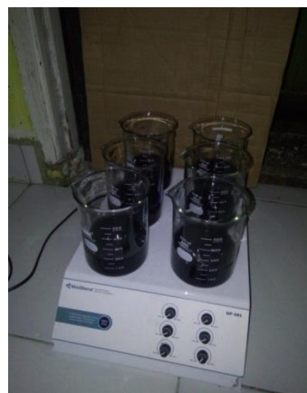
Gambar C.8. Impregnasi Katalis Berpengembangan Karbon Aktif dengan Larutan Basa KOH
