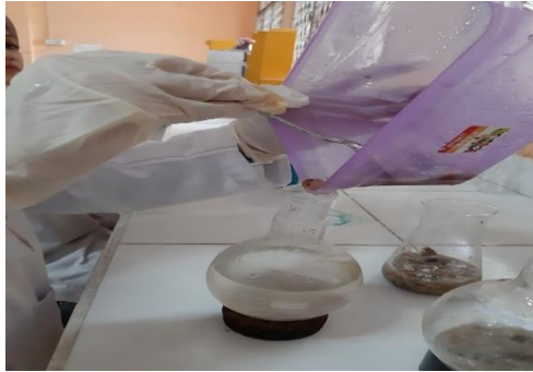
Gambar 12. kulit sapi dari proses demineralisasi kemudian di masukkan dalam labu leher 2 untuk proses ekstraksi
