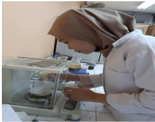
Gambar 23. Analisa kadar abu dimulai dengan menimbang masing-masing sampel 1gram kemudian dimasukkan ke dalam furnace dengan suhu 600°C selama 6 jam
