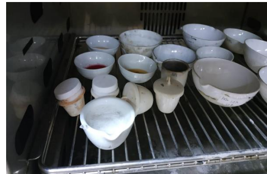
Gambar25. proses Analisa kadar air, dimulai dengan menimbang 1 gram sampel kemudian dimasukkan kedalam oven dengan suhu 105°C selama 5 jam
