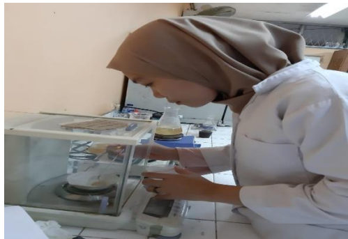
Gambar25. proses Analisa kadar air, dimulai dengan menimbang 1 gram sampel kemudian dimasukkan kedalam oven dengan suhu 105°C selama 5 jam
