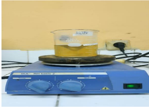
Gambar 15. proses pemekatan dengan menggunakan proses pemanasan dengan pengadukan pada suhu 60^{\circ} selama 5 jam
