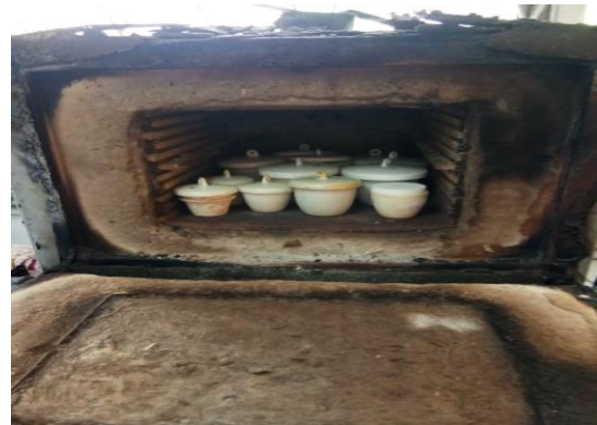
Gambar 23. Analisa kadar abu dimulai dengan menimbang masing-masing sampel 1gram kemudian dimasukkan ke dalam furnace dengan suhu 600°C selama 6 jam
