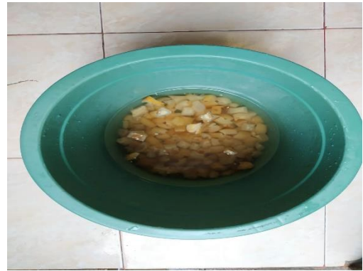
Gambar 6. kulit sapi yang telah dilakukan proses perebusan, dan siap untuk di demineralisasi
