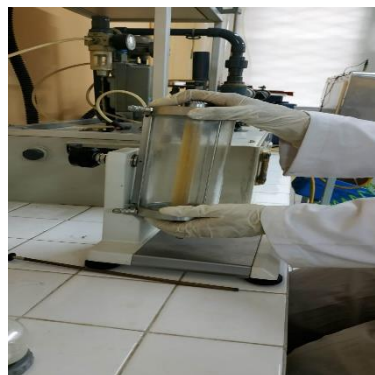
Gambar 26. Uji Viskositas, dengan membuat larutan 6,67% gelatin
