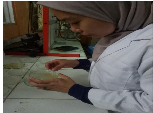
Gambar 22. Uji pH, larutan 6,67% gelatin diukur pH nya dengan menggunakan kertas pH
