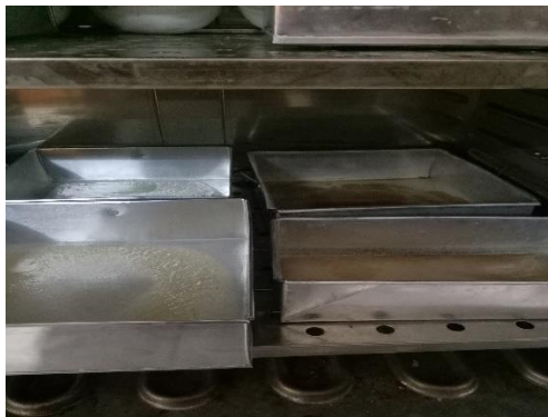
Gambar 17. proses pengeringan dilakukan pada suhu 60^{\circ}\text{C} selama 24 jam
