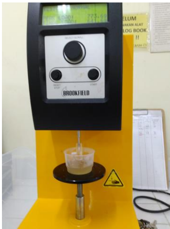
Gambar 27. Analisa kekuatan gel dengan menggunakan alat TA- textur analyzer
