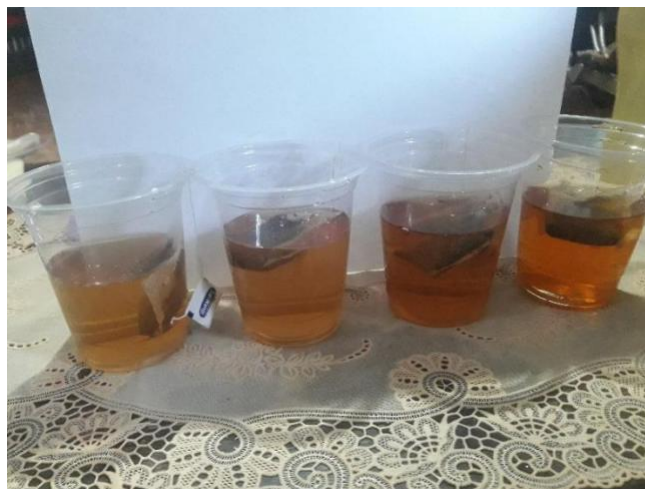
Air pH 7, 8, 9, 9.5 yang telah di celupkan 6x langsung berubah menjadi berwarna walaupun bukan air panas
