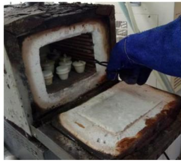
Dikalsinasi pada suhu 600°C di dalam furnace
