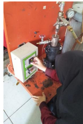
Mengatur Temperatur pada thermocontroller
