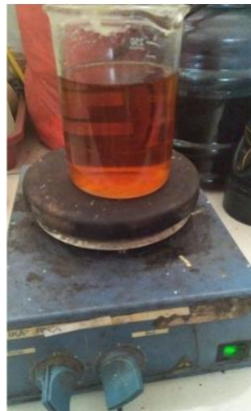
PFAD dipanaskan dengan menggunakan hot plate
