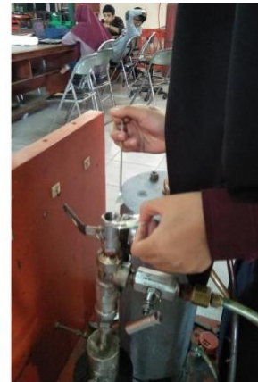
Memasukkan Katalis ke dalam reaktor
