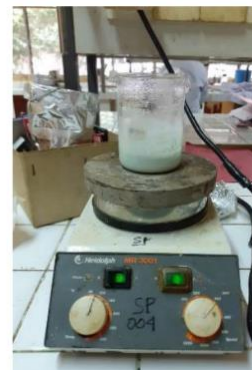
Pengeringan pada suhu 80^{\circ}\text{C}
