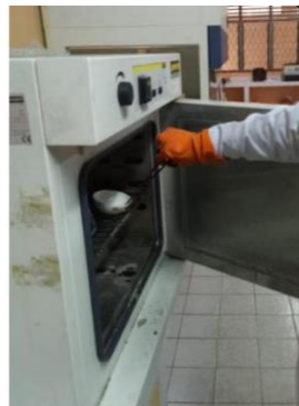
Dikeringkan pada suhu 120^{\circ}\text{C} di dalam oven
