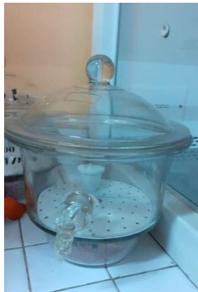
Katalis yang didinginkan di dalam desikator
