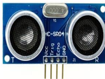
Gambar 2.6 Konfigurasi Pin Sensor Ultrasonik HC-SR04
