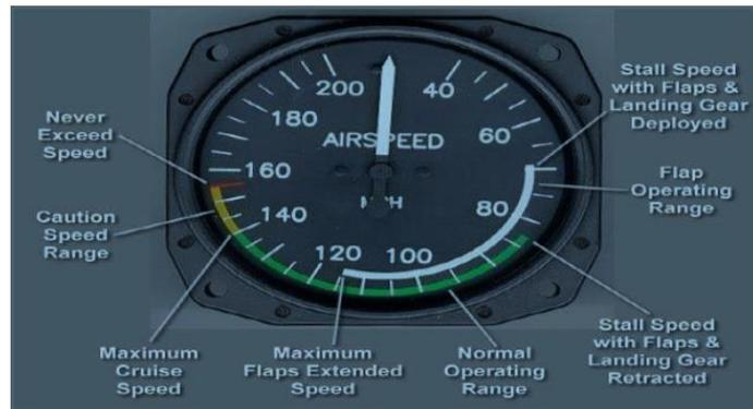
Gambar 2.13 Penjelasan tanda pada indikator kecepatan udara
