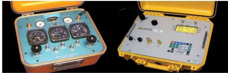
Gambar 2.14 Unit uji sistem analog pitot-statis (kiri)
