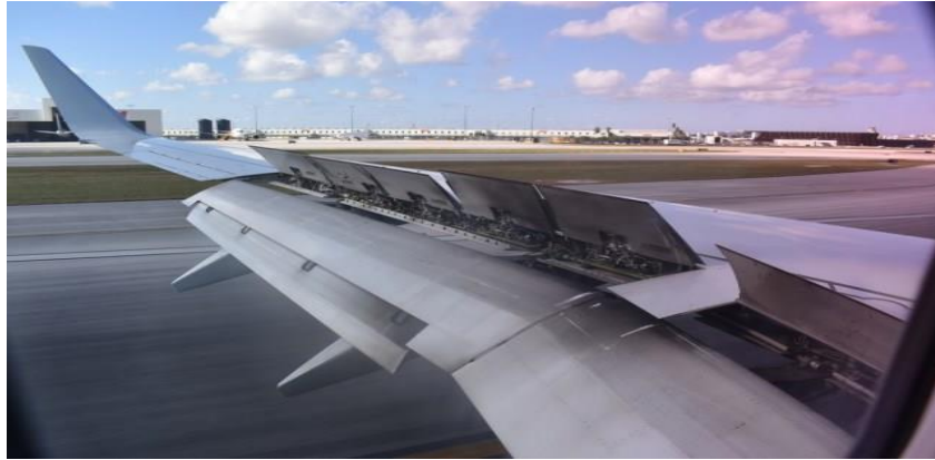
Gambar 2.7 spoiler pada pesawat (AeroEngineering,2016)
