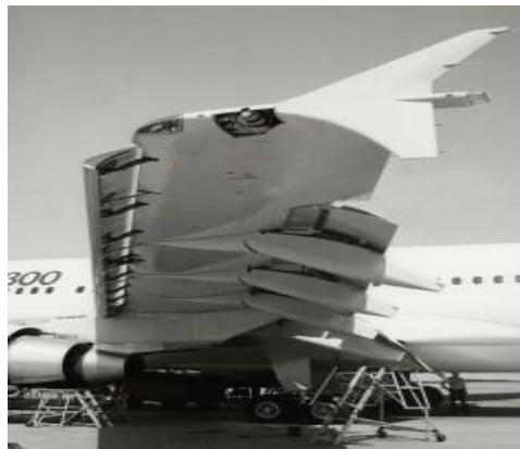
Gambar 2.5 Slat Pada Pesawat (AeroEngineering, 2016)
