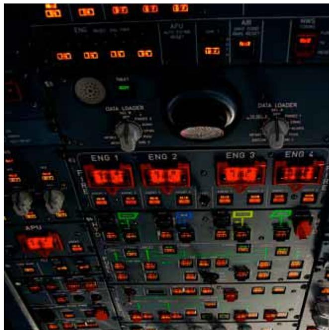
Gambar 2.9 Fire Switch untuk Engine dan APU di Overhead Panel Tengah pada Cockpit (GMF AeroAsia, 2015)
