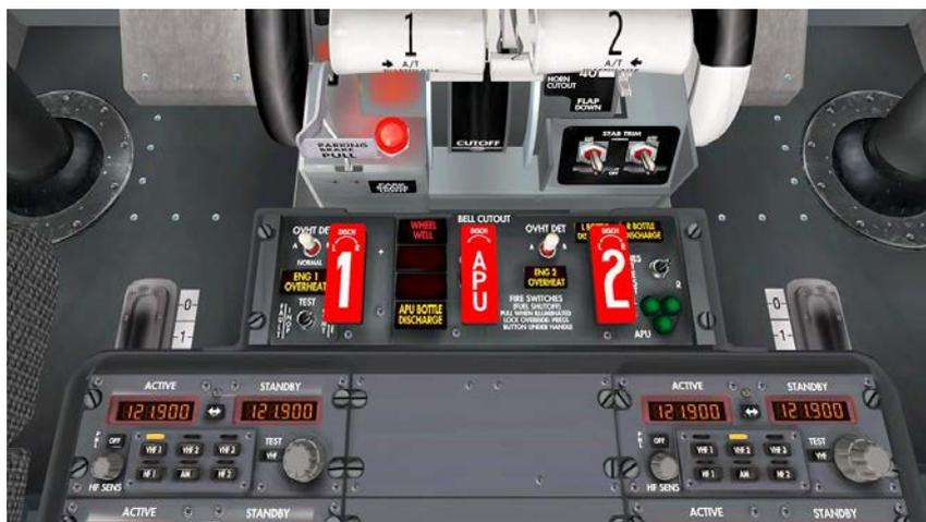
Gambar 2.8 *Fire Extinguisher Panel* pada Boeing 737 (GMF AeroAsia, 2015)
