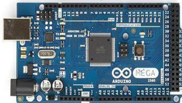
Gambar 2.17. Arduino Mega 2560 (Arduino Mega Datasheet, 2013)
