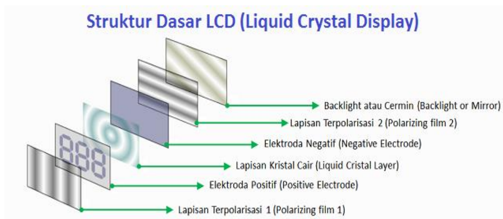
Gambar 2.26. gambar struktur dasar sebuah LCD
