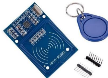
Gambar 2.15. Modul RFID MFRC522. (Supriatna, 2007)
