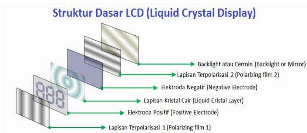
**Gambar 2.26. gambar struktur dasar sebuah LCD**
