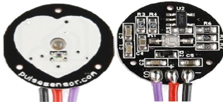
Gambar 2.3 Sensor Pulse Tampak Depan dan Belakang ( Hartono, 2013 )
