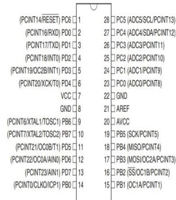
Gambar 2.13 Konfigurasi Pin ATMEga328
