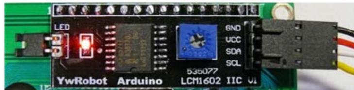
Gambar 2. 16 Komunikasi 4 kabel I2C (Aruma, 2017)
