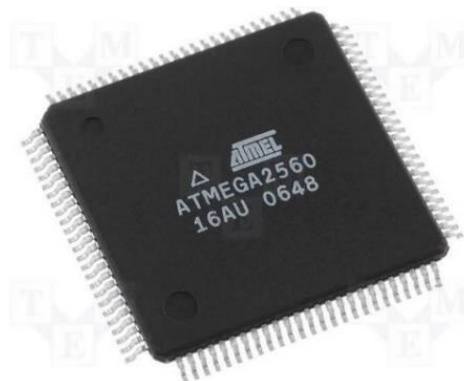
Gambar 2. 8 ATmega 2560 pada Arduino Mega 2560 (Sumber : Atmel Corporation.2014 )
