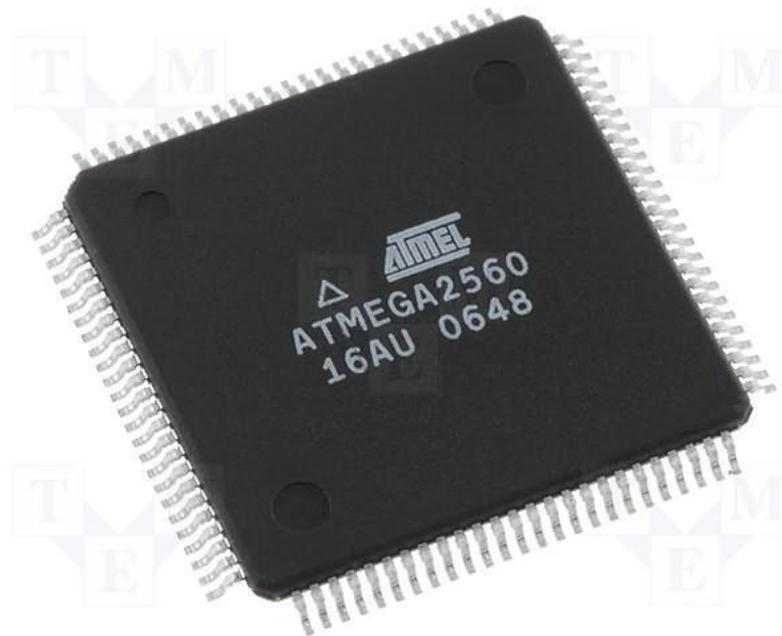
**Gambar 2.18** ATMega 2560 pada Arduino Mega 2560
