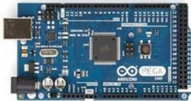
Gambar 2.1 *Board* Arduino Mega 2560 Tampak Depan
