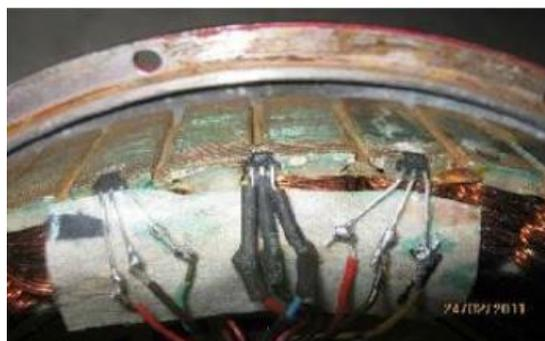
**Gambar 2.13** Posisi Hall Sensor Pada Motor BLDC
