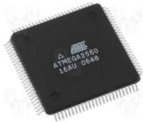
**Gambar 2.12** ATMega 2560 pada Arduino Mega 2560
