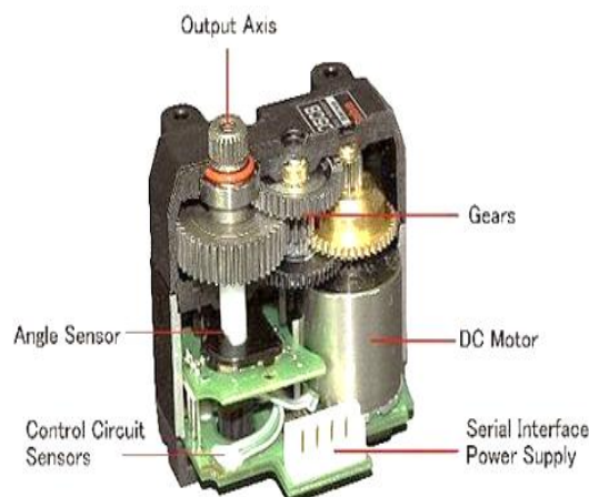
Gambar 2.8 Konstruksi Motor Servo (Purnama, Agus., 2012)
