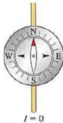
Gambar 2.6 (a) Percobaan Oersted Untuk Membuktikan GGL dapat Menimbulkan GGM
