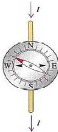
Gambar 2.6 (c) Percobaan Oestred Untuk Membuktikan GGL dapat Menimbulkan GGM
