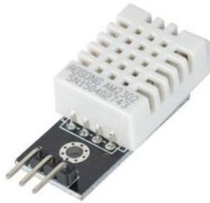
**Gambar 2. 3** Sensor DHT22
