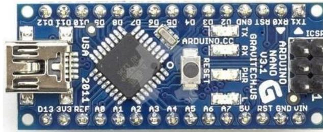
**Gambar 2.1** Bagian Depan *Arduino Nano*
