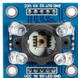
**Gambar 2.13** Sensor Warna TCS 3200
