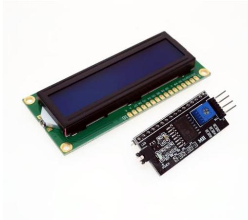
Gambar 2.17 LCD 16x2 dengan I2C Module (Ajie, 2016)
