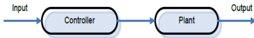
Gambar 2.2 Diagram Blok Sistem Pengendalian Loop Terbuka
