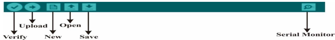
Gambar 2.8 Toolbar Arduino IDE
