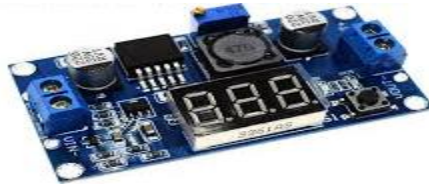
Gambar 2.15 Module Stepdown LM2596
