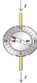
Gambar 2. 11 Percobaan Oestred Untuk Membuktikan GGL dapat Menimbulkan GGM
