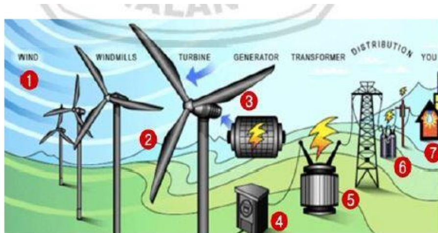
Gambar 2.6 Prinsip Kerja Pembangkit Listrik Tenaga Angin
