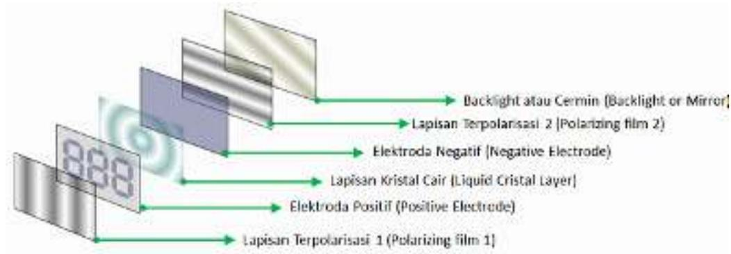
**Gambar 2.8** Struktur Dasar LCD
