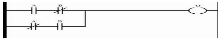
Gambar 2.16 Diagram Rangkaian XOR
