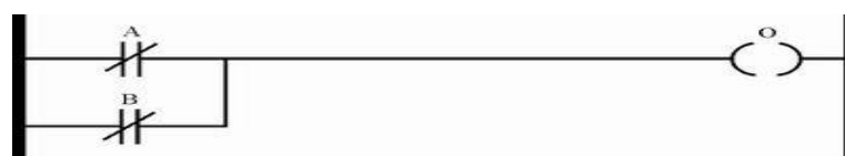
Gambar 2.15 Diagram Rangkaian NAND
