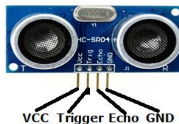
Gambar 2.11 Konfigurasi Pin dan Tampilan Sensor Ultrasonik HC-SR04 (Sumber: http://skp.unair.ac.id/repository/GuruIndonesia/SENSORULTRASONIK )
