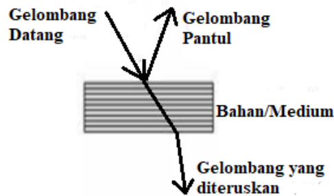
Gambar 2.4 Proses pemantulan gelombang infra red (Raden, 2011)
