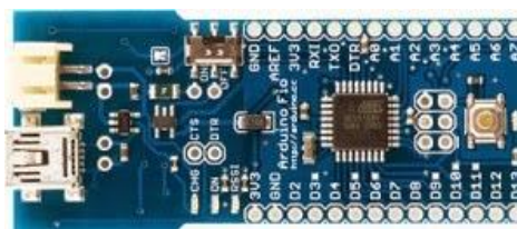
Gambar 2.5 Bentuk Fisik Arduino Fio
