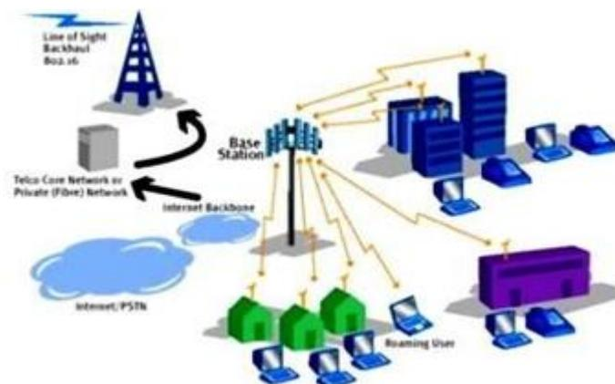
**Gambar 2.24 Konfigurasi Umum Jaringan WiMAX untuk Aplikasi MAN**
