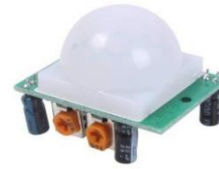
Gambar 2. Sensor PIR (Sumber : Riskiono, S.D, 2018)
