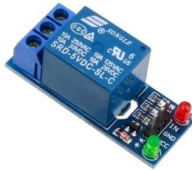
Gambar 2.6 Modul Relay<sup>[6]</sup>
