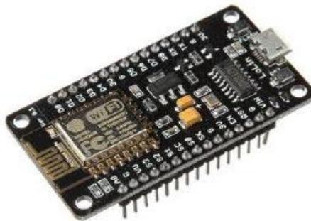
Gambar 2.1 Bentuk fisik Node MCU<sup>[1]</sup>
