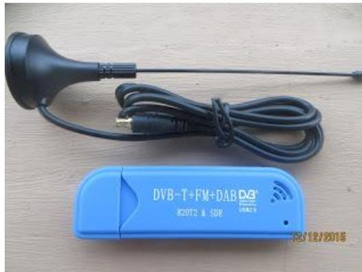
**Gambar 2.1** RTL-SDR (RTL2832U)
