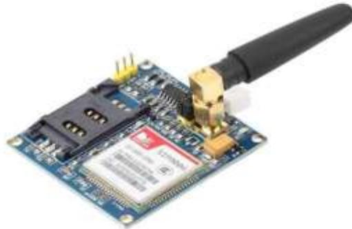
Gambar 2.9 Tampilan modul GSM SIM900.[9]
