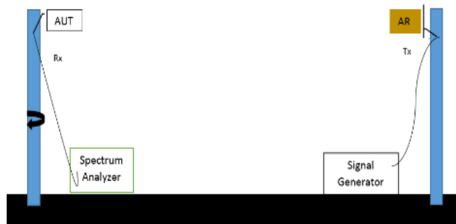
Gambar 6.1 Diagram Dasar Pengukuran Antena
