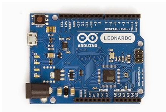
Gambar 2.9 Bentuk Fisik Arduino Leonardo
