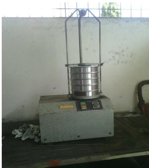
Gambar Lampiran 3.4 Proses Pengayakan Bentonit dan Abu
