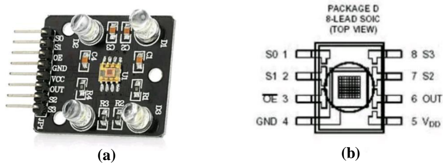
Gambar 2.2 (a) bentuk fisik sensor TCS3200 (b) skema pin sensor TCS3200
