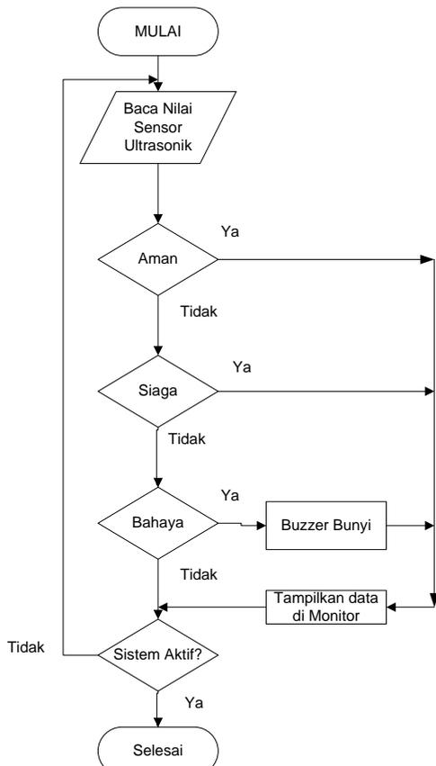
Gambar 2. Diagram Alir Untuk Sensor Ultrasonik
