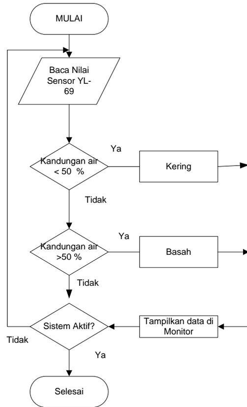
Gambar 3. Diagram Alir Untuk Sensor Kelembaban YL-69
