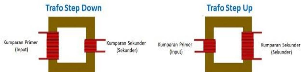
Gambar 2.10 Trafo *Step Up* dan Trafo *Step Down*<sup>[8]</sup>
