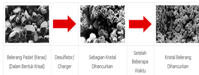
Gambar 2.35 Siklus perubahan zat belerang pada aki
