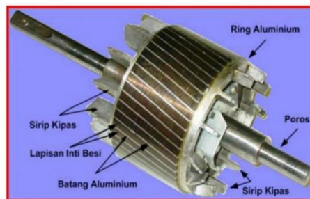
Gambar 2.8 Rotor Sangkar [4]
